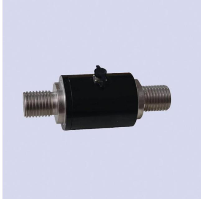
传感器输出信号一般为毫伏信号，分为四线加一根屏蔽线，分别是红黑绿白四根线，黄色为屏蔽线，红色为传感器供电正，黑色为传感器供电负，绿色为信号输出正，白色为信号输出负，由于拉力传感器可测量拉力和压力两种力值，绿色线和白色线可在接线时调换。传感器精度一般为万分之五的精度，传感器灵敏度一般为 $2.000\text{mV/V}$ ，阻抗基本是350欧，精加工技术精湛，传感器参数固定，材质选优质合金钢，数据稳定，精度高，寿命久。传感器适宜在零下20度至60度范围内工作，如需特殊要求，也可以跟销售沟通，定制高温传感器。
